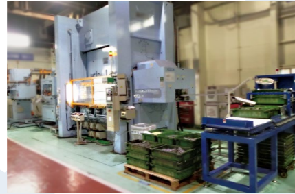
プレス機 + コンベヤ + コンテナストッカー + 架台
